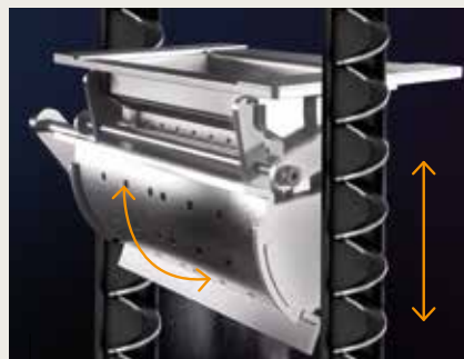
Simultáneamente con el vaciado del brasero, se activan los turbuladores que eliminan los restos de hollín eventuales de los intercambiadores (solo en algunos modelos hidráulicos)
