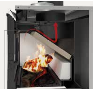
1- CON LA PUERTA CERRADA La válvula By-Pass está cerrada y los humos se dirigen al intercambiador de calor.
