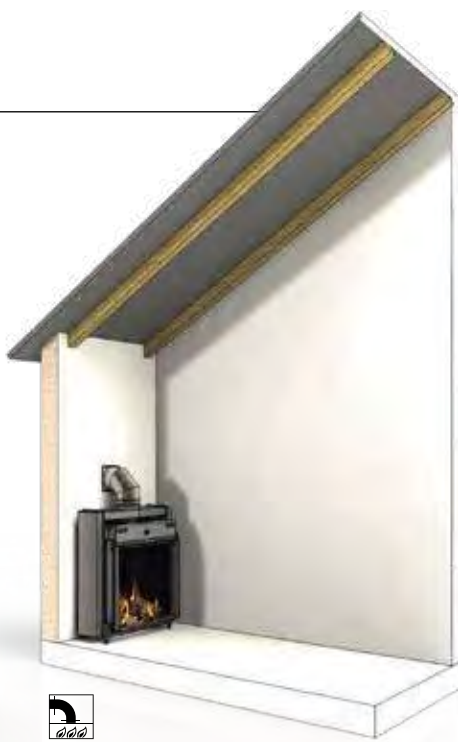
Por una pared exterior • directamente sobre el aparato con un codo de 90° hacia la pared exterior • Disponible para una gran parte de la gama de chimeneas
